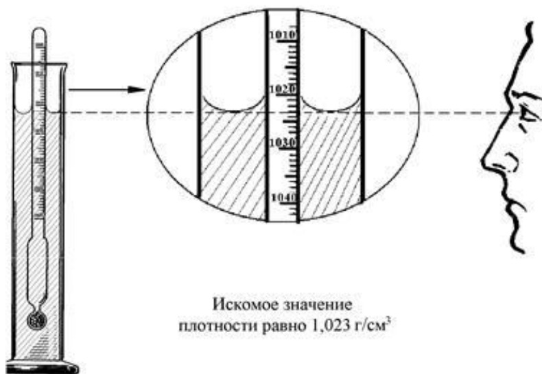
Рисунок 2. Отсчет по делениям шкалы ареометра
